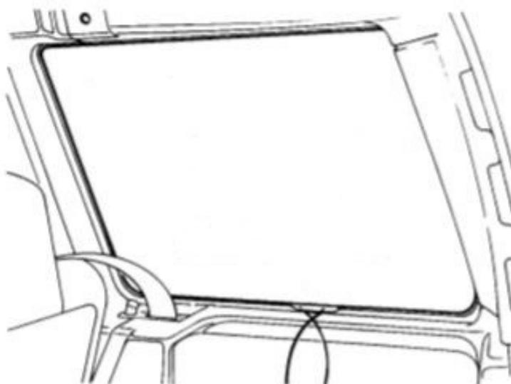
Figure 3 : Position de la ficelle à l'intérieur du véhicule
