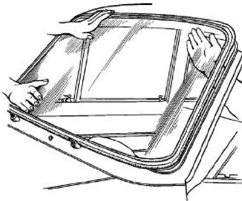
Figure 2 : Exemple de retrait d'une vitre montée dans un joint en caoutchouc
